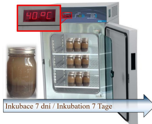
Abb. 12 Bestimmung des mineralisierbaren Stickstoffs in der Boden-Wasser Suspension.
