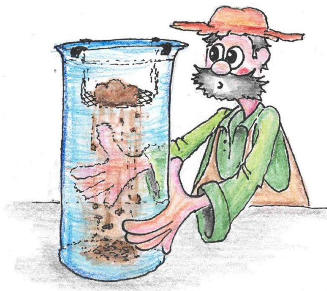
Abb. 7 Die Bodenaggregatstabilität gegenüber der Zersetzung durch Wasser ist ein grundlegender Indikator für die Bodenqualität.
