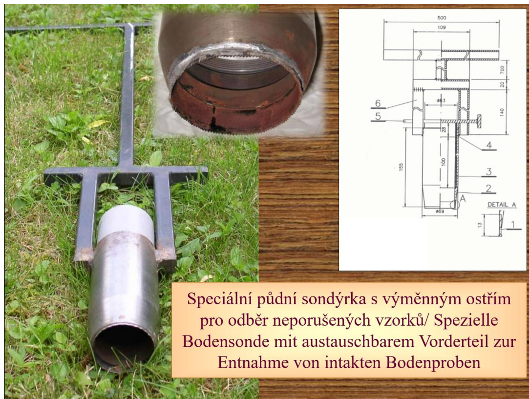
Abb. 4 Detailansicht des vorderen Teils der Sonde für intakte Bodenproben.
