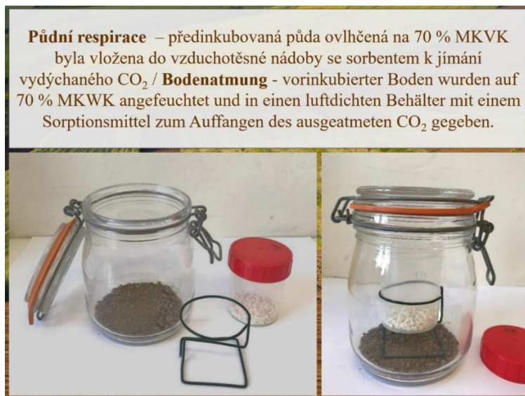
Abb. 11 Inkubationsgefäße, in denen der Boden für die Bestimmung der Bodenatmung inkubiert wurde.
