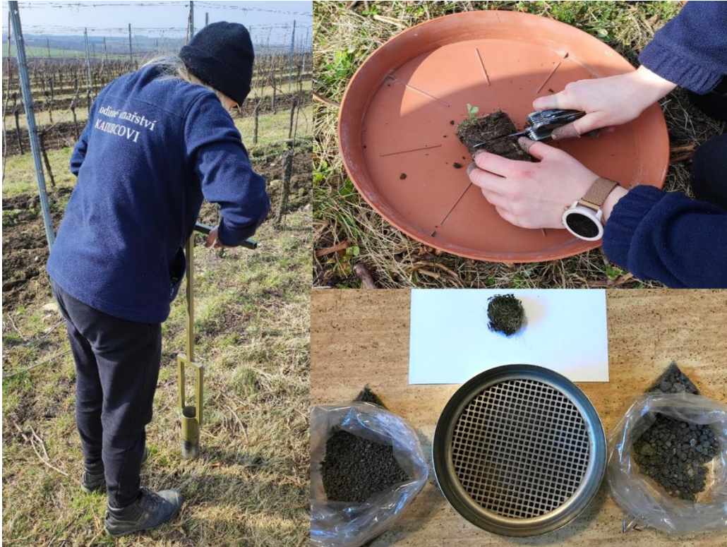
Abb. 5 Beispiel für die praktische Entnahme von Bodenproben im Weinberg und sofortige Absiebung in Fraktionen unter und über 5 mm (Foto von Jana Asszonyi, Mendelu).
