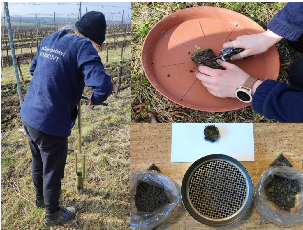
Obr. 5 Příklad praktického odběru půdních vzorků z vinohradu a jejich bezprostředního prosetí na frakce pod a nad 5 mm (foto Jana Asszonyi, Mendelu).
